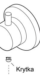
**D** Demontáž ovladače termostatické baterie
