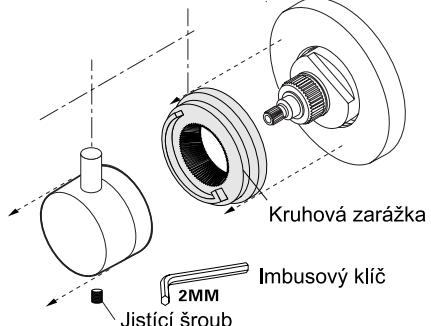
**E** Demontáž kartuše termostatické baterie
